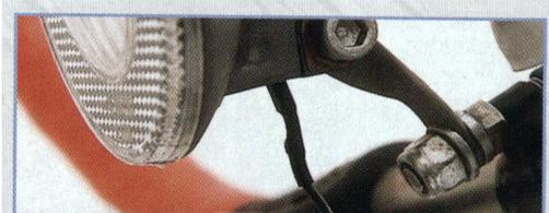
Kontaktprobleme bei der Masseleitung lassen sich im allgemeinen bereits durch das Anziehen der Befestigungsschrauben eliminieren. In sehr schwierigen Fällen hilft wiederum nur schmirgeln, bis die Metalloberflächen im Kontaktbereich blitzblank sind.
